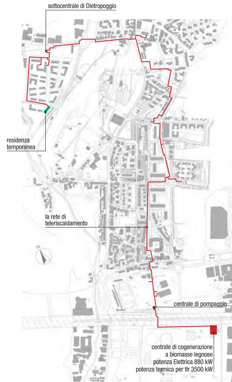
rete distributiva di teleriscaldamento del Comune di Calenzano
